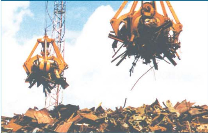
광산, 항만, 제철소 등에서 석탄, 자갈, 모래, 곡물, 고철 등을 리프팅하는 장치
